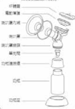
將含負壓閥的喇叭罩 喇叭殼安裝在喇叭殼 頂上(如左圖)。
